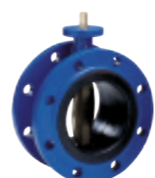
Serie 75/20 Centrisk butterflyventil med fast gummiliner Dobbeltflange, kort Duktiljern Med alle typer aktuatorer
