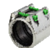
Serie 745/01 Repico Grip kobling Universal og trækfast for alle metalrør Rustfrit stål AISI 316 NBR eller EPDM DN15-400
