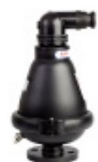
Serie 701/75 Kombinationsudluftningsventil Udluftningsareal: Automatisk: 12 mm 2 Kinetisk: 804 mm 2 Forstærket nylon Indløbsflange eller 2" 3" BSP-gevind DN50-100 PN10
