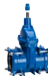
Serie 01/70 Supa Plus™ skydeventil med trækfaste koblingsender til PE- og uPVC-rør DN40-300 PN16 Duktiljern
