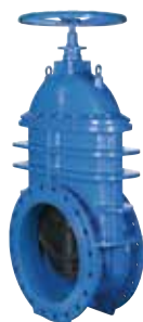
Serie 06 Flangeventil Byggelængde DIN F4 DN450-1200 PN10/16 Blødtættende Duktiljern
