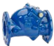
Serie 41/61 Kontraklapventil Blødtættende Lukkede bøsninger DN50-300 PN10/16 Duktiljern
