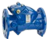
Serie 41/60 Kontraklapventil Blødtættende Fri akselende DN50-300 PN10/16 Duktiljern
