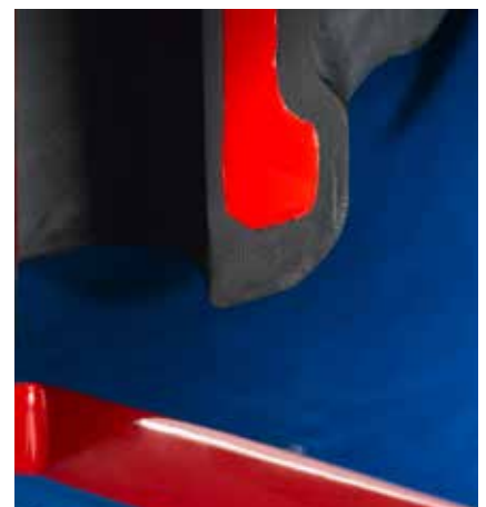
Når ventilen åbnes igen, vil gummi genvinde sin oprindelige form.
