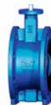
Serie 813/80 Butterflyventil Centrisk med løs gummiliner Dobbelt flange kort DN350-600 PN10/16 Duktiljern
