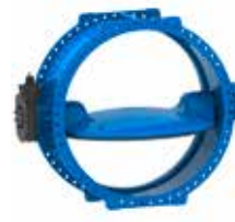
Serie 756/102 Butterflyventil Dobbelt-excentrisk Dobbeltflange Sæde af rustfrit stål ISO input gearboks DN150-2800 PN10/16 Duktiljern
