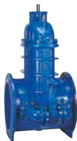
Serie 55/30 Flangeventil DN450-500-600-800 Byggelængde DIN F5 PN10/16 Blødtættende Udskiftelig spindelpakning Duktiljern
