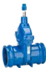
Serie 01/80 Skydeventil med "Euro" mufteender til uPVC-rør DN40-400 PN16 Duktiljern
