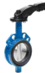
Serie 820/00 Butterflyventil Centrisk med løs gummiliner Wafer DN25-1000 PN10/16 Duktiljern
