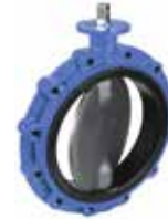
Serie 75/41 Butterflyventil Centrisk med fast gummiliner Full lug DN50-1200 PN10/16 Duktiljern
