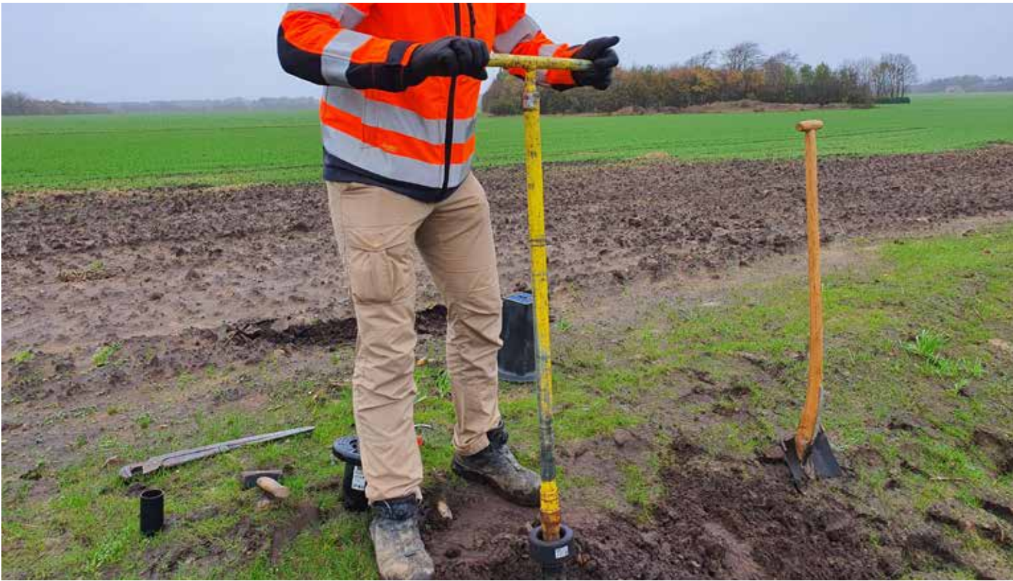
VIDI Positioner er kalibreret og klar til at registrere skydeventilens åbningsgrad
